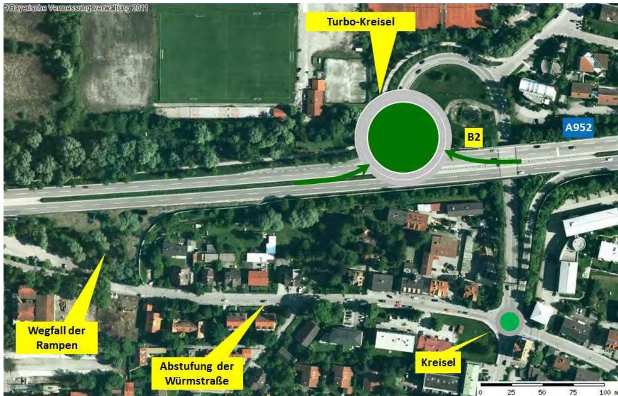
Bild 4 Alternative 3: Anschluss Percha über einen 2-streifigen Kreisel
