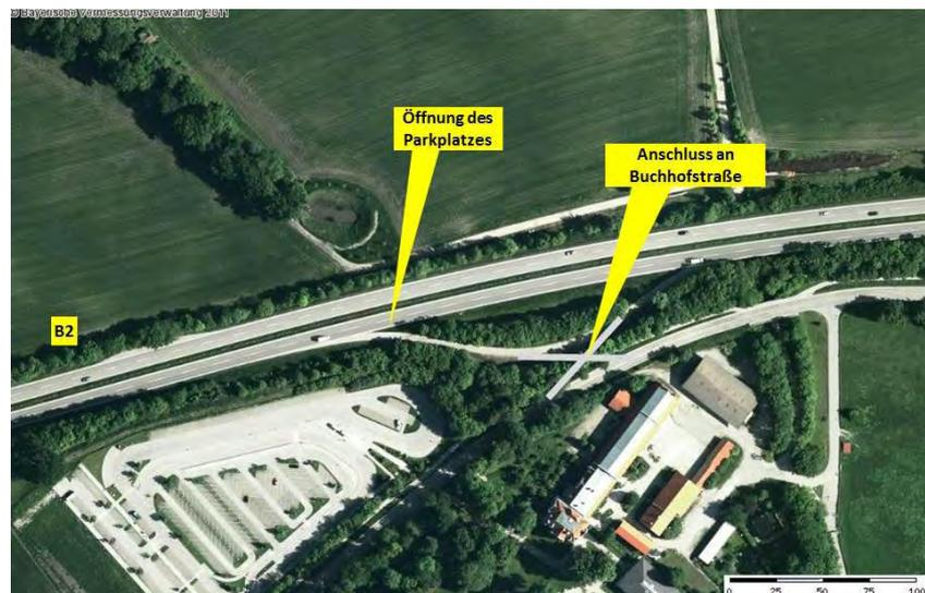
**Bild 2** Anbindung der MIS über den Parkplatz der A952 bzw. einer B2n
